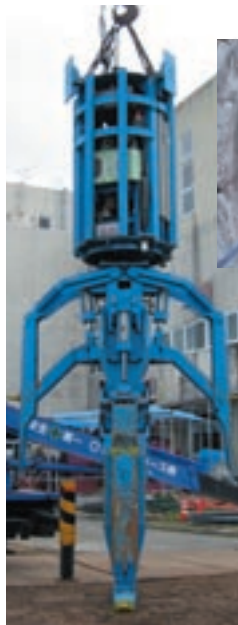
レンガ解体機と施工状況
