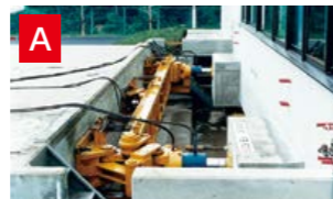
自由振動実験装置(200トンジャッキ・2基)
