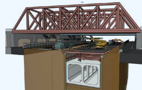
重機配置シミュレーション
