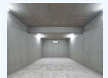
床衝撃音・固体伝搬音を検証できる「床衝撃音実験室」(写真は、同実験室内の「壁式構造型実験室」)
