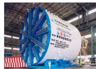
世界最大級の泥土圧シールド機(外径12.02m)
