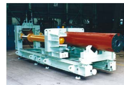
スーパーミニ工法のシールド機
