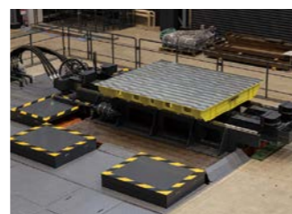
長周期振動台(上段)と3次元振動台(下段)
