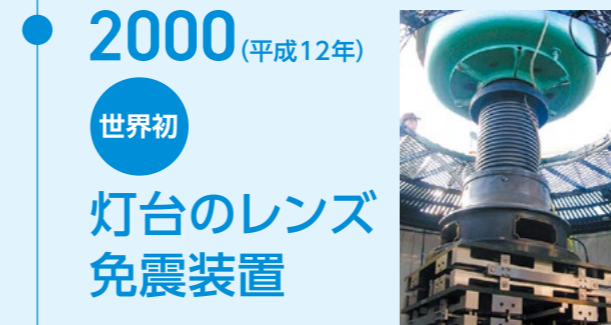
灯台レンズ用免震装置
