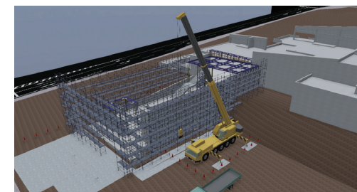
BIM検討図(鉄骨工事・仮設工事)
