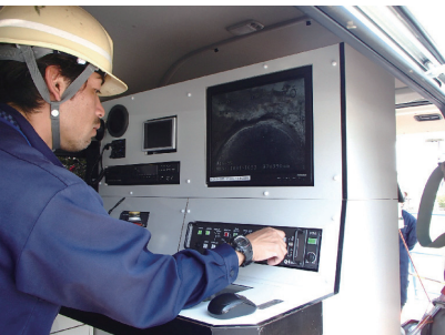
カメラ調査モニター確認
