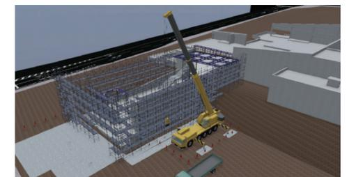
BIM検討図(鉄骨工事・仮設工事)
