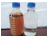
左：汚染水(重油) 右：処理水
