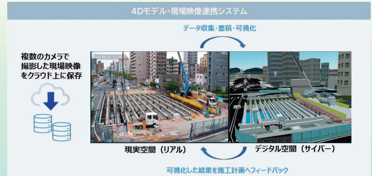
4Dモデル・現場映像連携システムの概要
