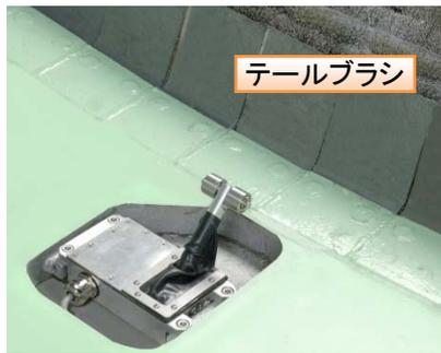
写真-1 テールクリアランス自動計測装置の設置状況図
