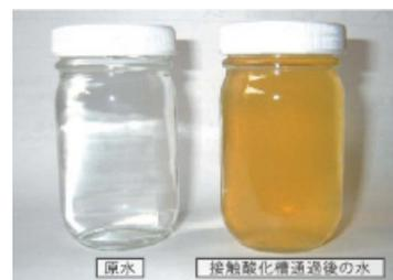
接触酸化による鉄分の析出
