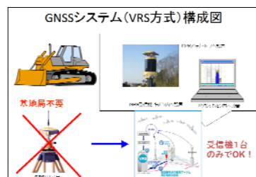
図-2 GNSS(VRS方式)機器構成
