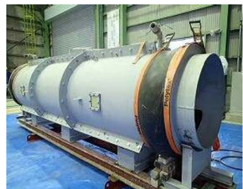
写真-2 実物大の充填実験用鋼製型枠
