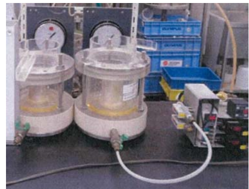
写真-1 透気試験状況
