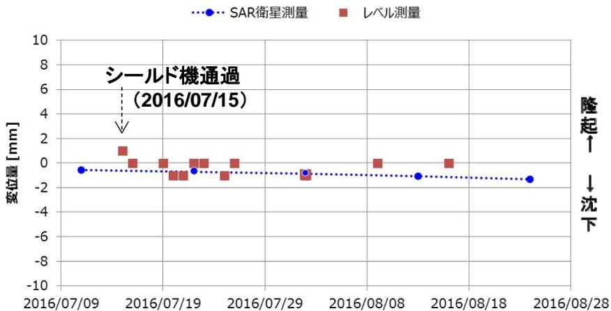
図-2 No.28 地点付近における変位測量結果の比較
