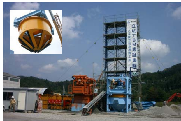
立坑TBM実証実験装置 (実証実験装置全体及びφ2.4m カッタヘッド)
