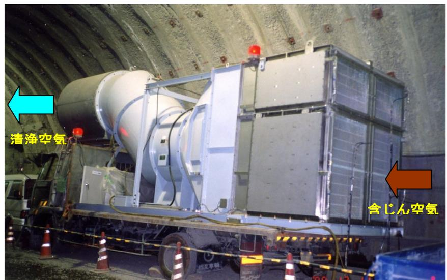
写真-1 クリンジェット(車載型:2000 $m^3$ /min)
