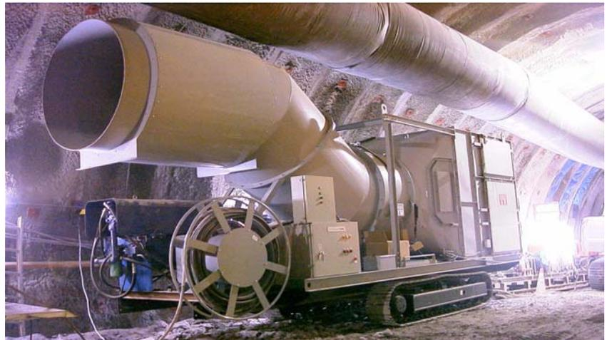
写真-2 クリンジェット(クローラ台車搭載型:2000m<sup>3</sup>/min)
