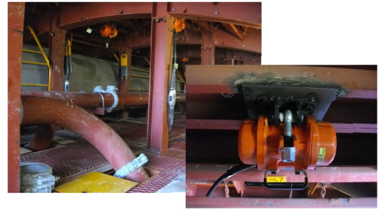
写真 3 型枠バイブレータ
