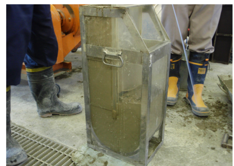
写真 2 U 型充填試験
