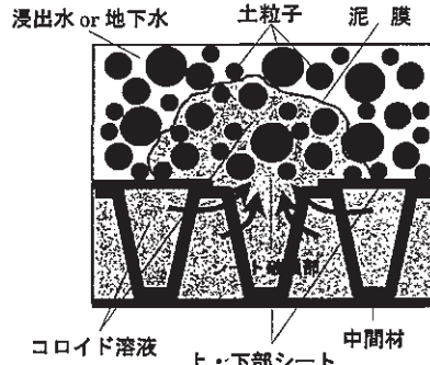
図-3 コロイド溶液の修復原理
