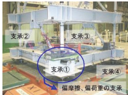
写真-1 付加質量の設置状況 ～ 偏荷重時 ～
