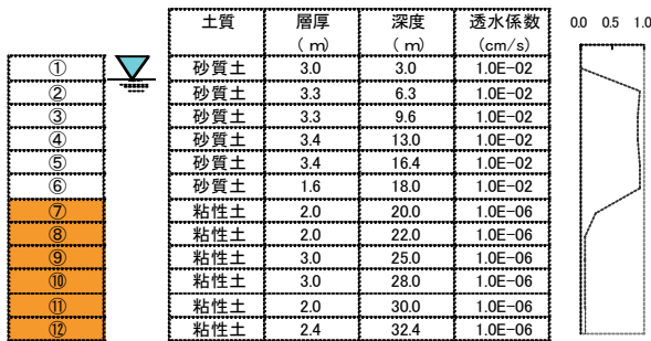
図-2 地盤モデル（一次元解析）
