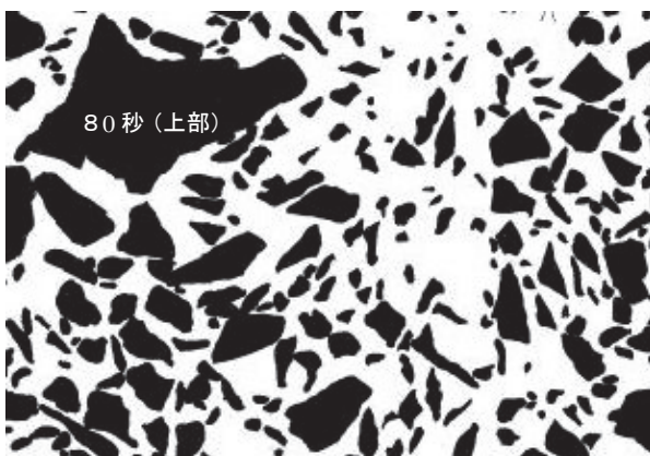
図-8 骨材の粒度分布 (締固め時間 80 秒)
