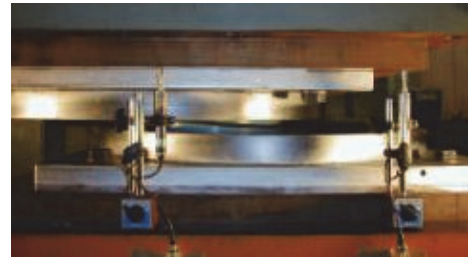
写真-2 軸力载荷のすべり試験
