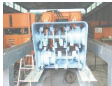
写真－1 パドル式矩形掘進機
