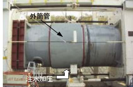
写真-5 外圧負荷実験状況
