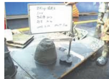
写真-9 搬送土の性状 (スランプ: 11cm)
