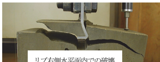
リブ右側水平面内での破壊
