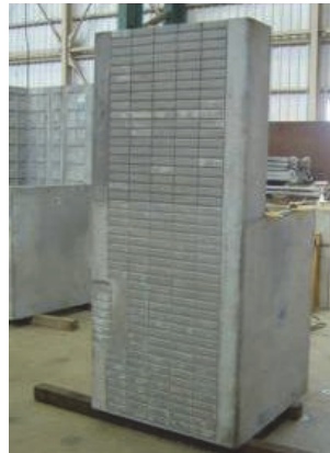
写真-9 遠心成形 出来形[外壁面]
