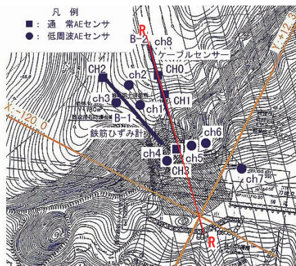
図-3 雷電トンネル終点斜面の AE 観測点配置 (左: 平面図、右: 断面図)
