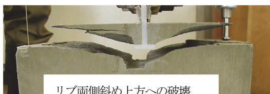
写真-1 リブの引抜要素実験
