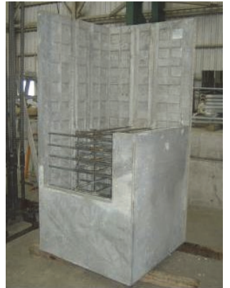
写真-12 流し込み成形 出来形[内面]
