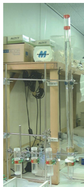
写真-1 模擬逆洗状況(セメント成分を付着させた膜を逆さにして約 1m の水頭をかけ、膜の剥離性を確認)
