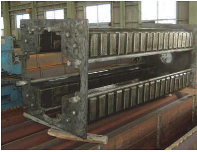
写真-3 遠心内型枠
