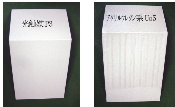
写真-3 つくば暴露6ヶ月の試験体表面 (例)
