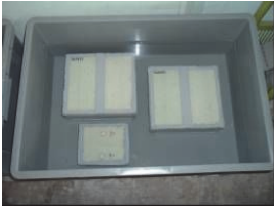
写真-4 パネル試験体の硫酸浸せき状況
