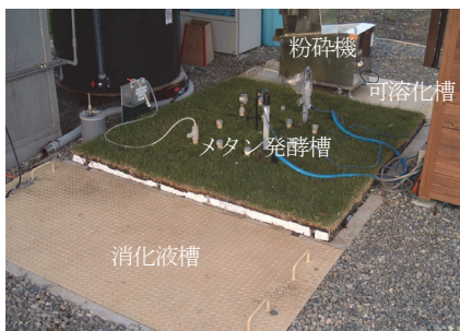
写真-3 小規模メタン発酵実験設備
