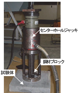
写真-1 接合部の引張実験
