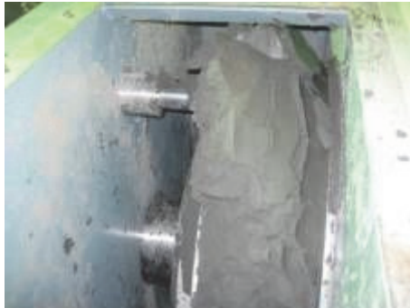
写真-6 スクリュープレス排土部 (脱水後)
