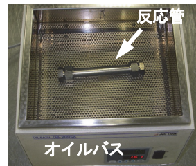
写真-1 亜臨界水処理状況
