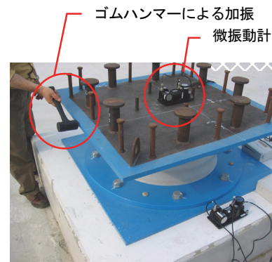
免震装置単体試験の状況
