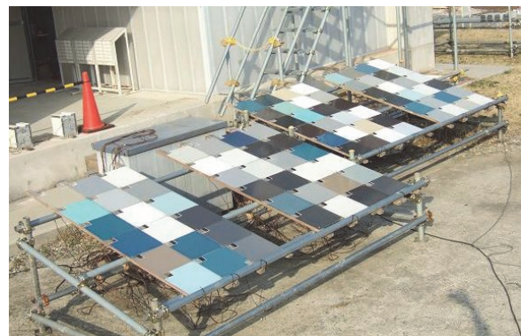
写真-1 H18.9~屋外曝露状況
