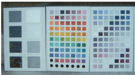
写真-3 色見本帳による遮熱性能測定
