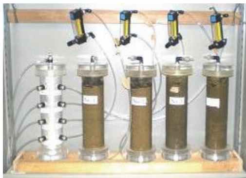
写真-3 エアースパーキング実験状況
