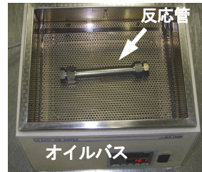
写真-1 亜臨界水処理状況
