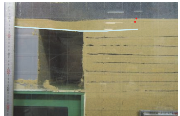
(a) 地盤崩壊前の土層 (引抜き距離 128mm)
