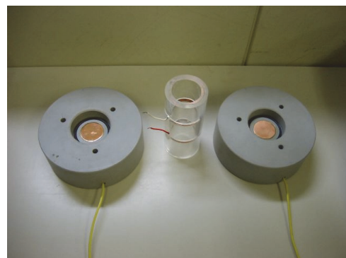
写真-1 砂の比抵抗測定用アダプタ
