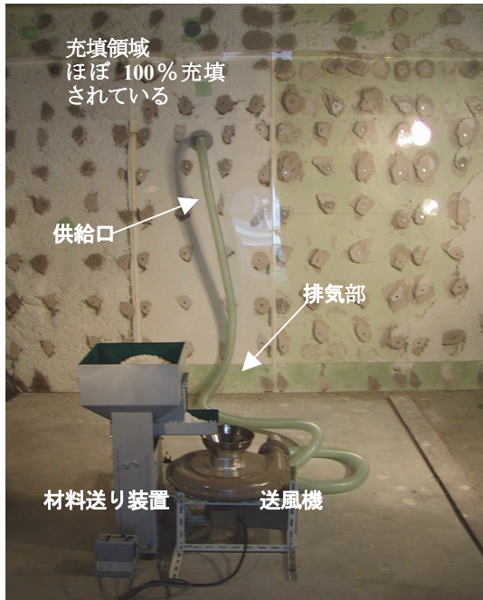
写真-4 吹き込み装置と試験状況
