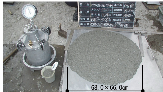
写真-1 フレッシュコンクリートの性状 (受入れ試験状況)
