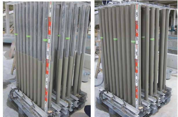
写真-12 実大グラウト充填実験の充填状況
