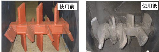
写真-15 使用前後の混合装置パドルの磨耗状況
