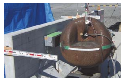
写真-1 鉄球衝突試験
