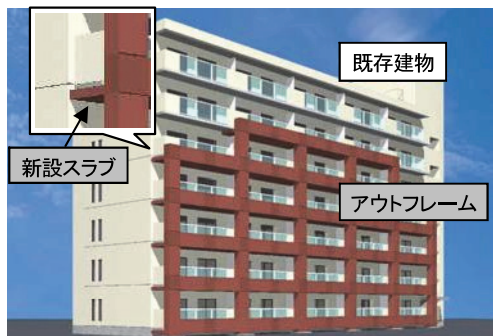
図-1 アウトフレーム耐震補強工法
