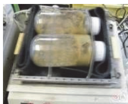
写真-1 洗浄状況 (振とう機、およびハンドミキサー)
