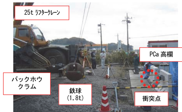
写真-7 鉄球衝突試験状況
