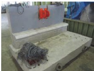
写真-2 直壁型場所打ちタイプ
