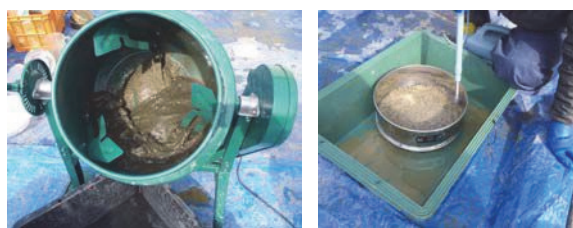
写真-3 ポットミキサーによる洗浄とすすぎ洗い状況
