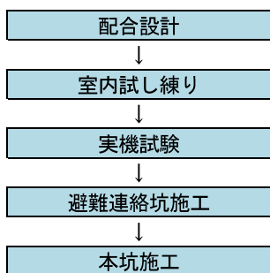
図-3 本坑施工までの実施フロー
