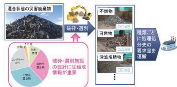
図-5 災害廃物の取り崩しイメージ
