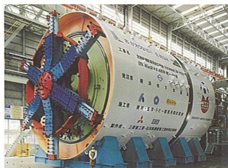
写真-1 球体式ビット交換を採用したシールド
