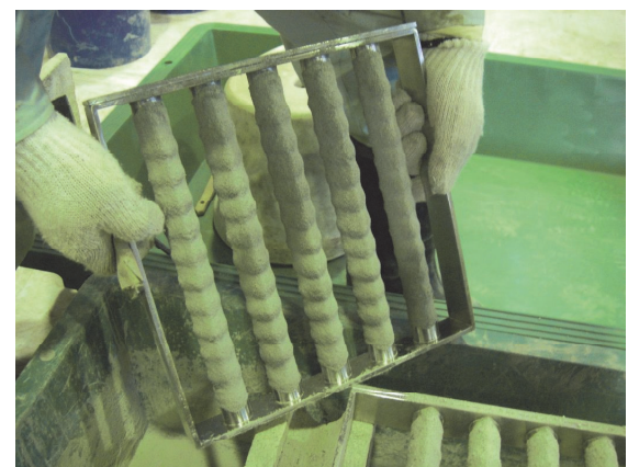
写真-4 磁着した試料
