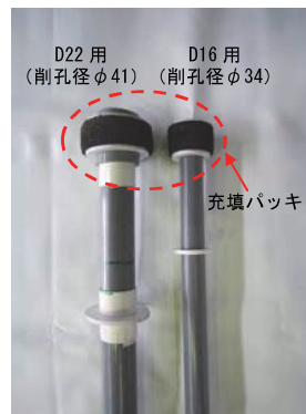
写真-4 充填パッキン付き充填治具
