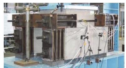
③ 既存柱と増し打ち部に鋼製治具を圧着
