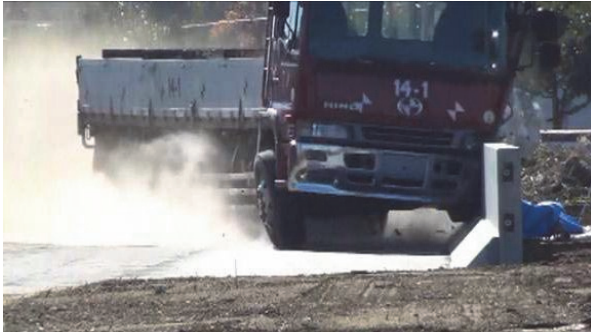
写真一 4 車両衝突試験状況 (条件 A)
