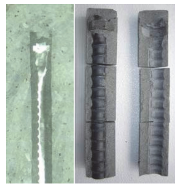
写真-7 上向き後施工の切断・割裂面
