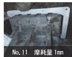
写真-2 ビット点検状況
