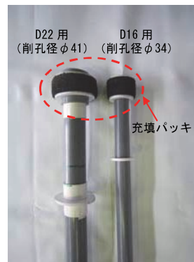
写真-4 充填パッキン付き充填治具
