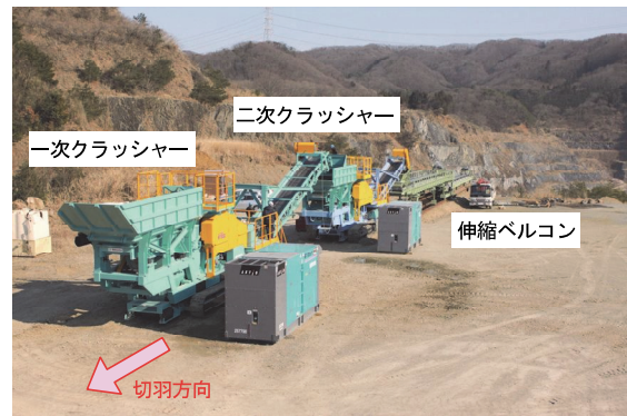
写真-1 クラッシャーと移動式伸縮ベルコンの配置 (実証試験サイト)
