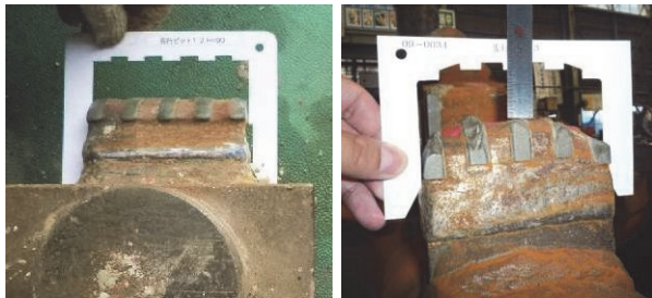
写真－8 側部の摩耗・チップの欠け
