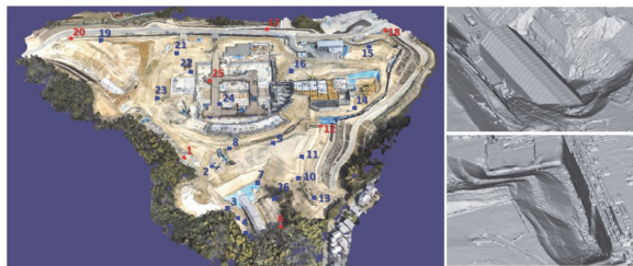
図-23 UAV計測による3次元モデル
