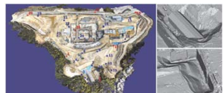
図-5 写真測量による3次元モデル
