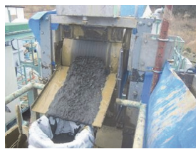
写真－10 鉄粉回収(磁力選別)
