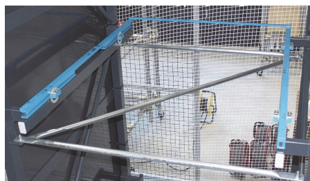
(d) パレット免震装置
