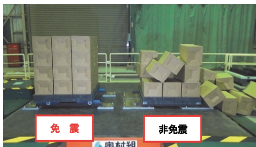
写真-3 振動台実験状況(加振終了後)
