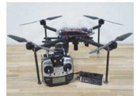
写真-1 UAV 測量装置
